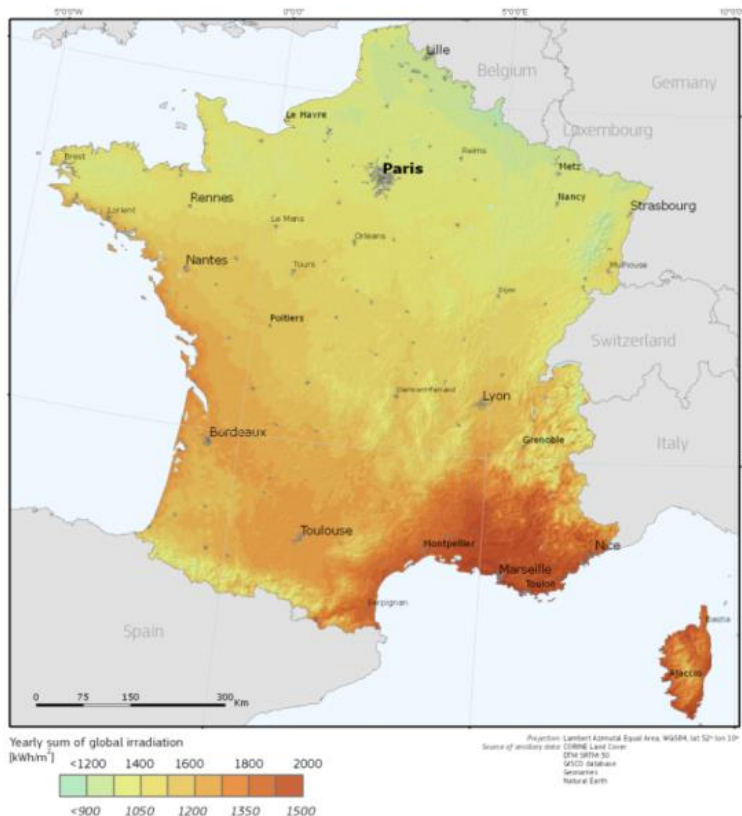
Figure 44 : Moyenne annuelle de l'énergie reçue sur une surface orientée au sud et inclinée d'un angle égal à la latitude (en kWh/m 2 .an), Source : PVGIS
